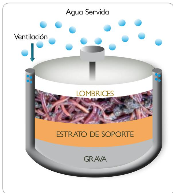
Figura 17. Esquema general de un lombrifiltro.
