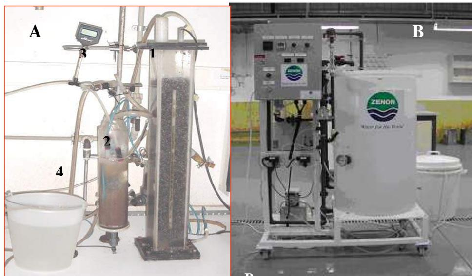
**Figura 2A.** Esquema del BRHM de laboratorio (1) Reactor aerobio gas-lift; (2) Cámara de filtración con módulo de membrana; (3) Vacuómetro; (4) Tanque de almacenamiento de permeado. **Figura 2B.** BRM a escala piloto Zenon ZW-10.
