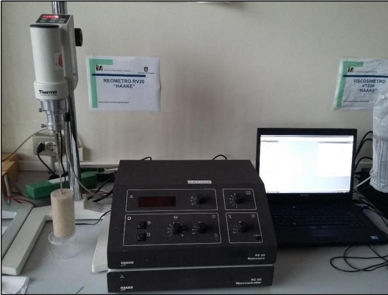
Figura 27: Reómetro RT V550 Hakke.
