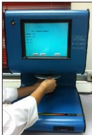
Figura 19. Medidor de blancura ISO, Technidyne color touch 2, Model ISO.
