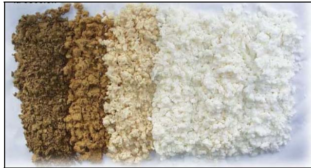
Figura 8. Proceso químico aplicado a pulpa café para aumentar su blancura.
